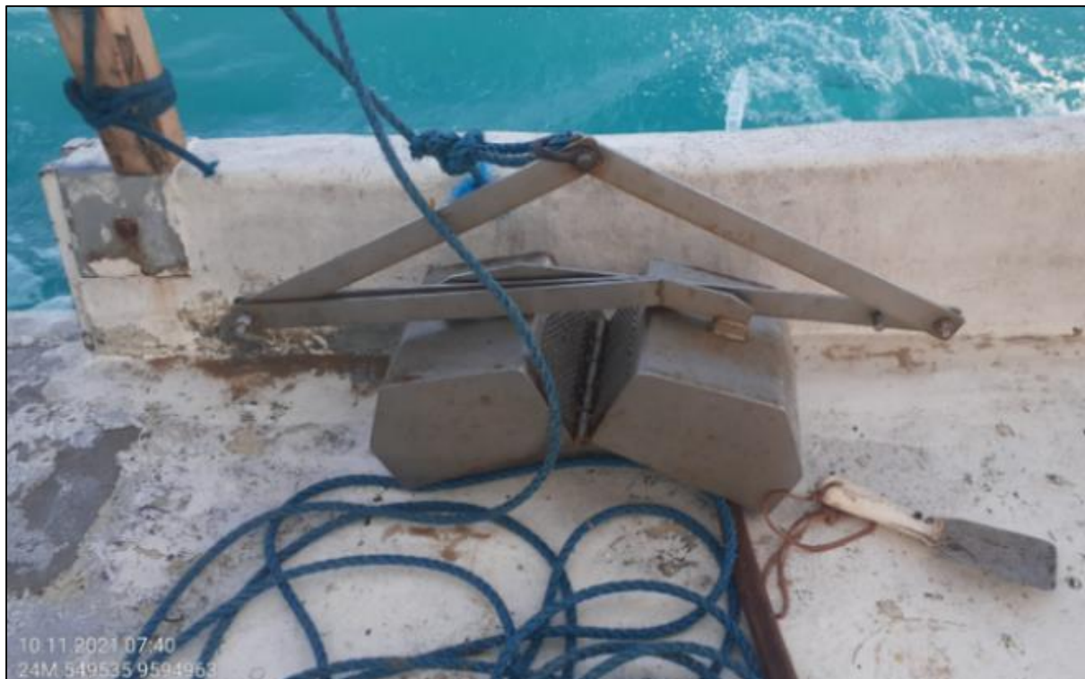
FIGURA 8-1 DRAGA VAN-VEEN SENDO UTILIZADA PARA COLETA DE SEDIMENTOS PARA COLETA DE BENTOS.
