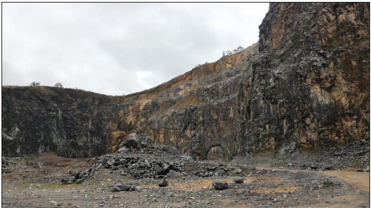
Figura 34 - Fonte de rocha e solo de aterro (parte superior) na jazida da Pedreira Rio Zoada. (relatório I-OAESV-R-R0/16-16-iv)
