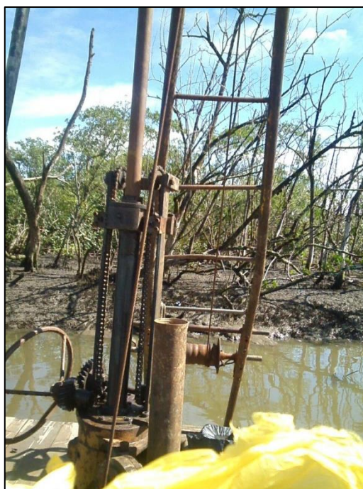
Foto 8 – Equipamento para sondagem rotativa no furo NSM-02.
