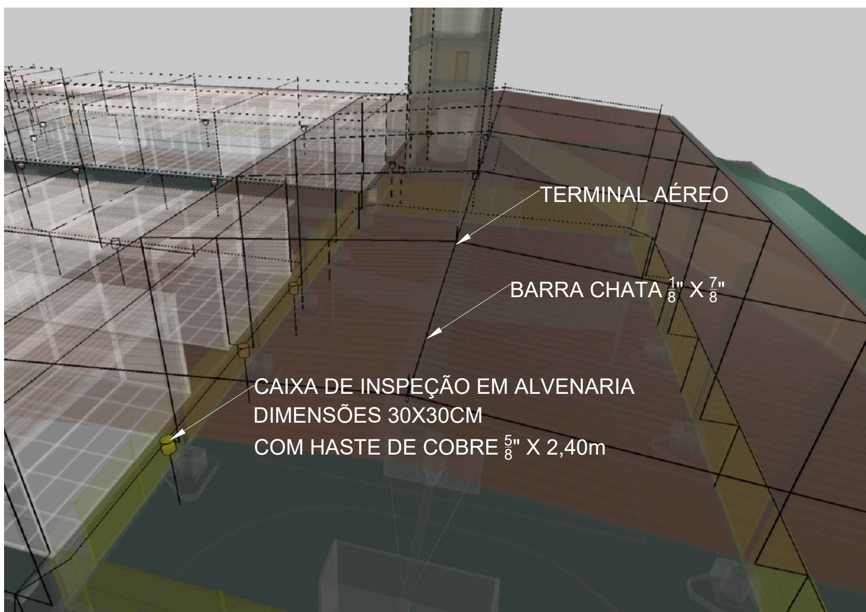
DETALHE GÊNÉRICO DE BARRA CHATA E TERMINAL AÉREO
