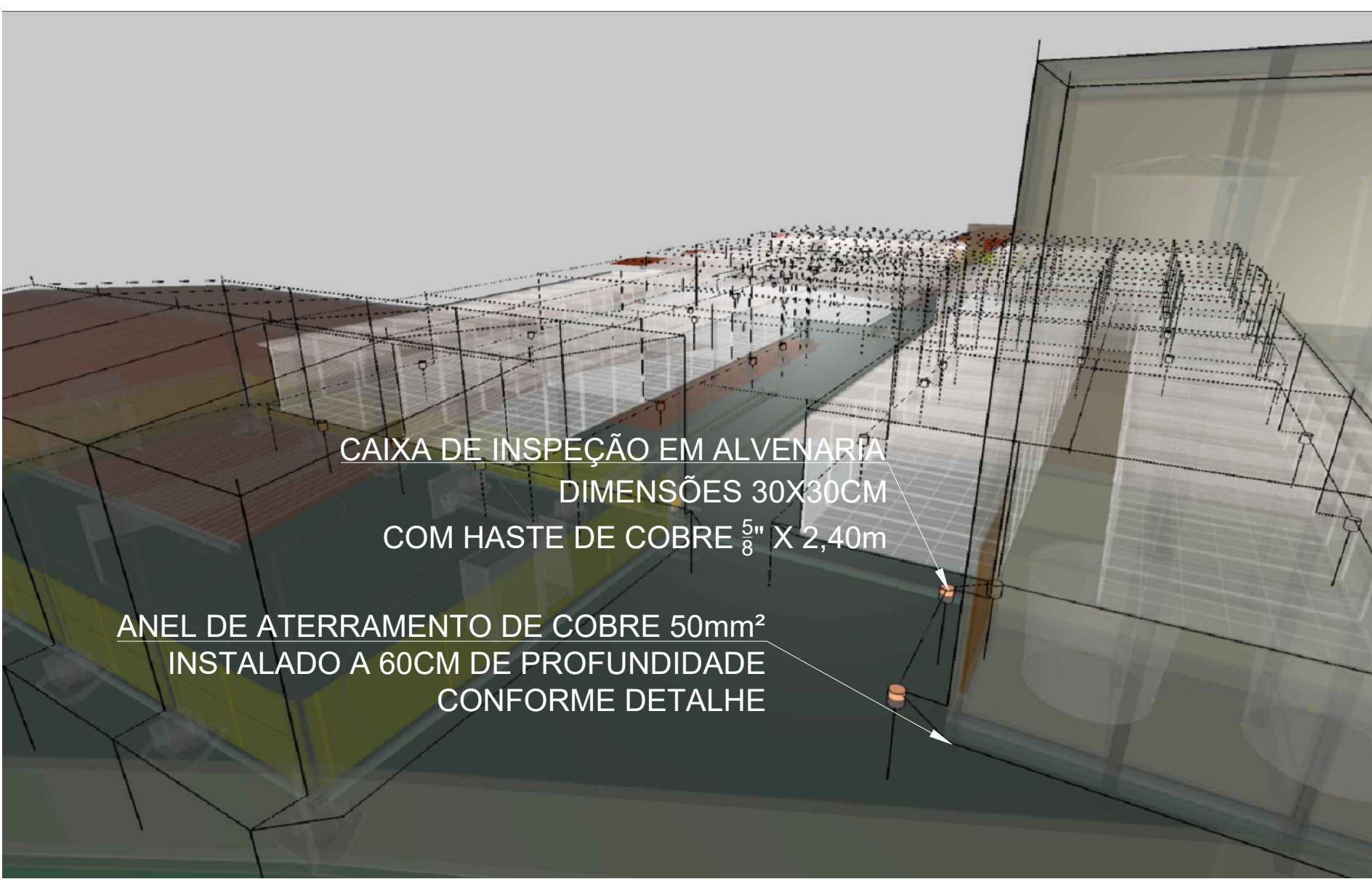
DETALHE GÊNÉRICO DE CAIXA DE INSPEÇÃO E ANEL DE ATERRAMENTO
