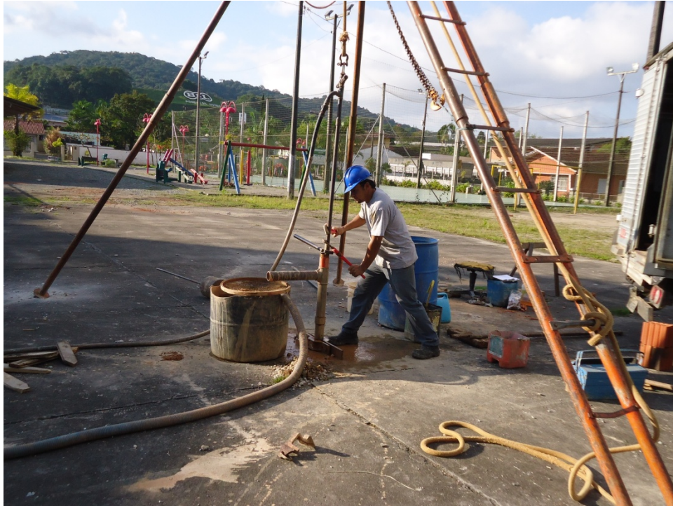
Figura 03 - Execução do furo de sondagem SPT-01.
