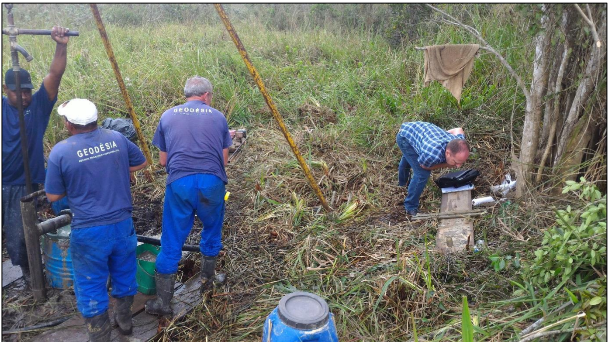
Foto 14 – Membro da fiscalização analisando amostra de solo extraída do furo NSP-02.
