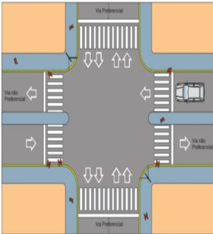
MODELO DE INSTALAÇÃO DAS PLACAS DE NOMENCLATURA DE VIAS E LOGRADOUROS PÚBLICOS (PNR) EM CRUZAMENTOS DO TIPO: "VIA PREFERENCIAL x VIA NÃO PREFERENCIAL".
