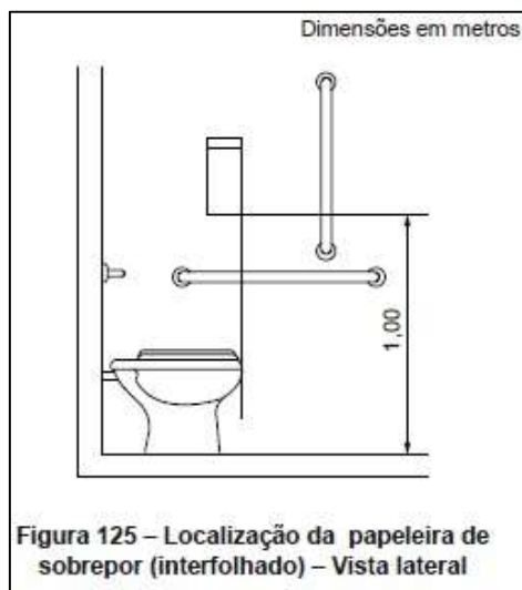
Figura 15 - Instalação de papeladeira nos sanitários acessíveis. Fonte: NBR 9050/2020
