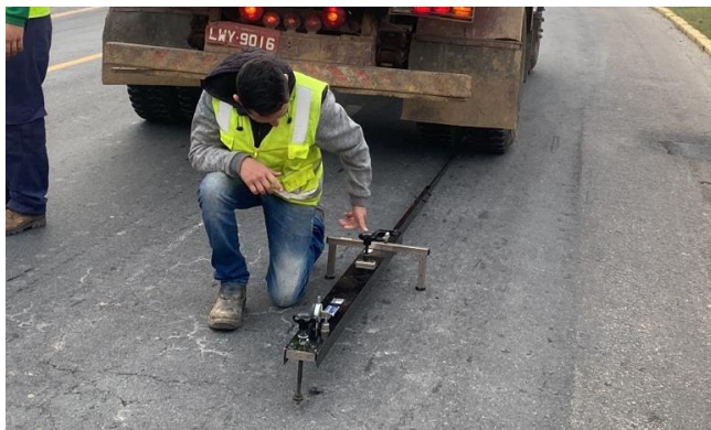
Figura 12.3 - Reflexão das trincas sobre o recapeamento recente.
