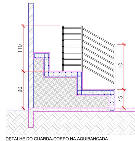
DETALHE DO GUARDA-CORPO NA AQUIBANCADA
