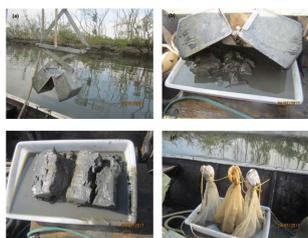
Método de amostragem de macrofauna bentônica. a) lançamento da draga Van-Veen. b) abertura da draga. c) amostra coletada. d) amostras armazenadas em sacos de tela e lacradas.
