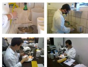
Métodos de processamento de amostras. a) Retirada da amostra do saco de tela e transferência para peneira de 0,5 mm. b) Lavagem da amostra em peneira de 0,5 mm para retirada de particulados finos. c) e d) Triagem de amostra de macrofauna bentônica para separação e identificação dos organismos.
