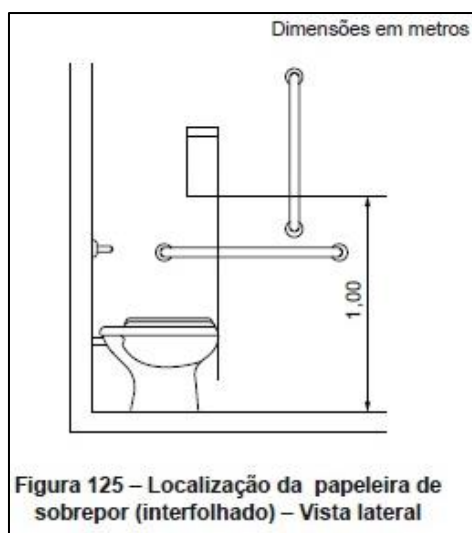
Figura 20 - Instalação de papeleira nos sanitários acessíveis. Fonte: NBR 9050/2020
