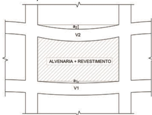
Figura 2 – Interação alvenaria x estrutura decorrente das flechas.
