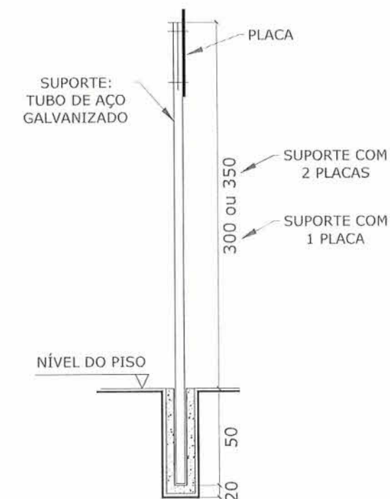
DETALHE DE FIXAÇÃO
