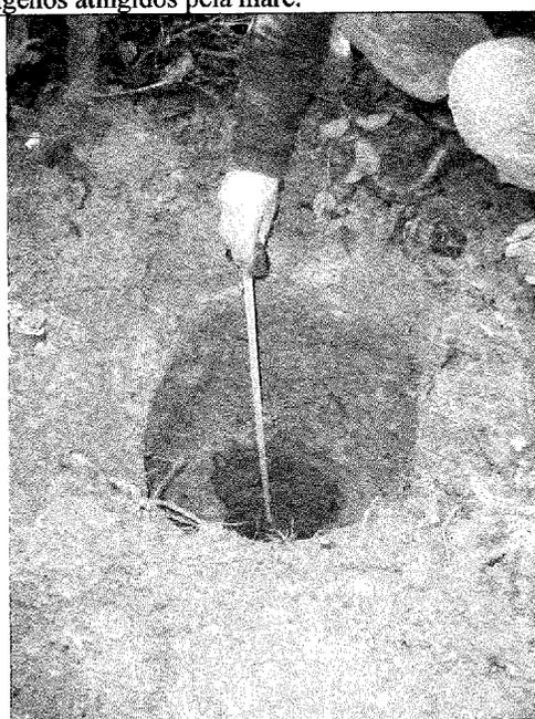
**Foto 33**– Característica dos aterros encontrados na faixa de mata, verificados através da execução de sondagem comprobatória.
