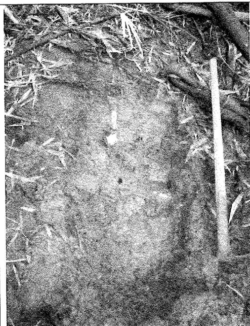
**Foto 34** – Realização de perfil no contato entre aterros recentes e canal de escoamento. Presença de sedimentos conservados abaixo de 2 metros
