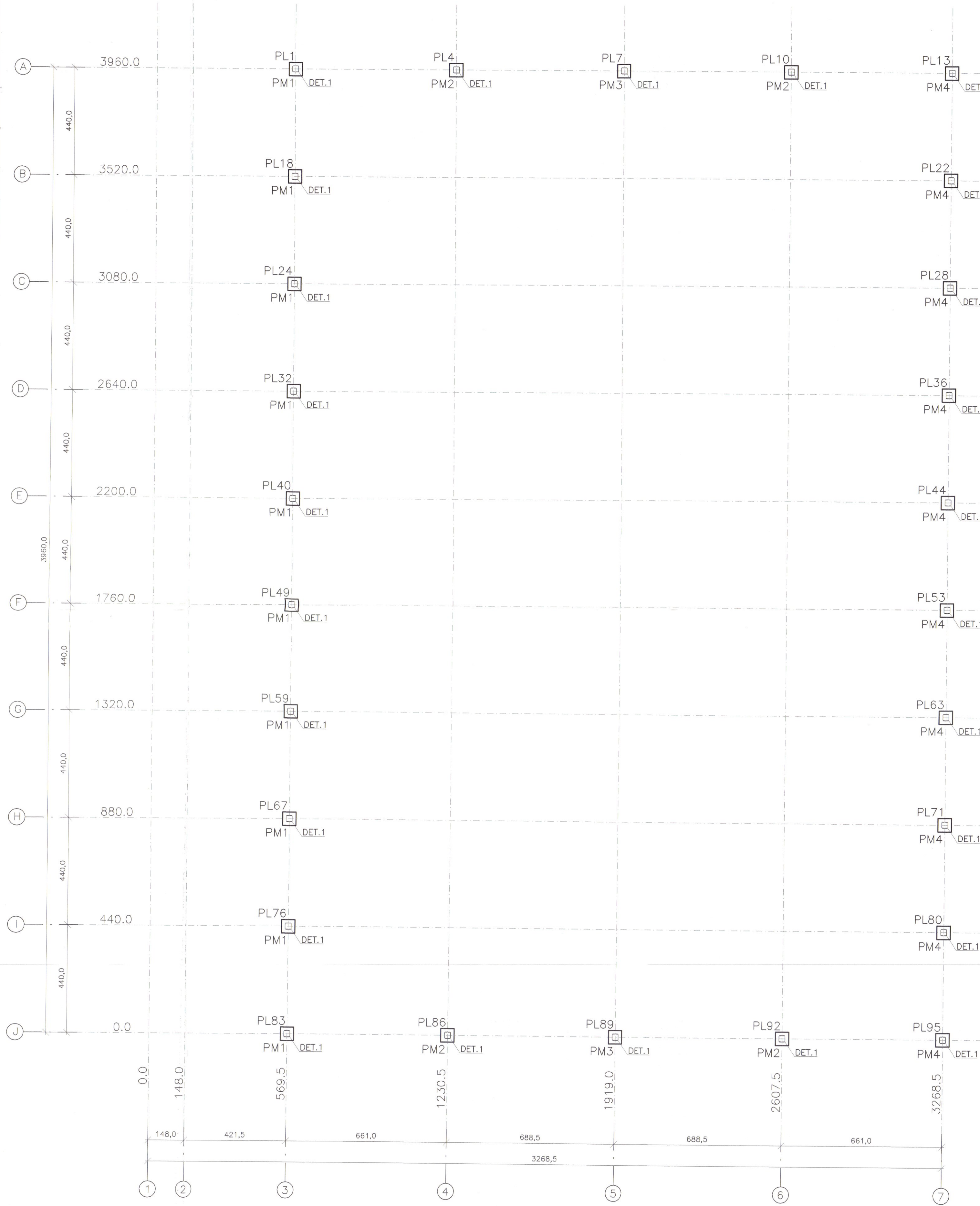
LOCAÇÃO DE CHUMBADORES ESC.: 1/100 (COTAS EM CENTÍMETROS)
