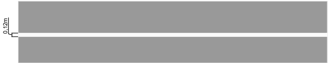
DETALHE B LINHA SIMPLES SECCIONADA BRANCA (2X4X2)
