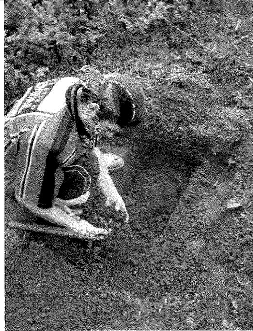
**Foto 26** – Rebaixamento gradual da sondagem comprobatória, com verificação do solo.
