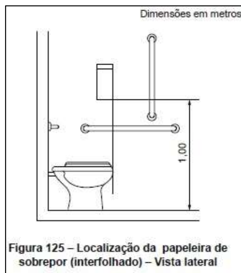
Figura 15 - Instalação de papeleira nos sanitários acessíveis. Fonte: NBR 9050/2020
