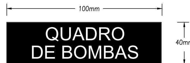
PLAQUETA DE IDENTIFICAÇÃO DO QUADRO DE DISTRIBUIÇÃO
