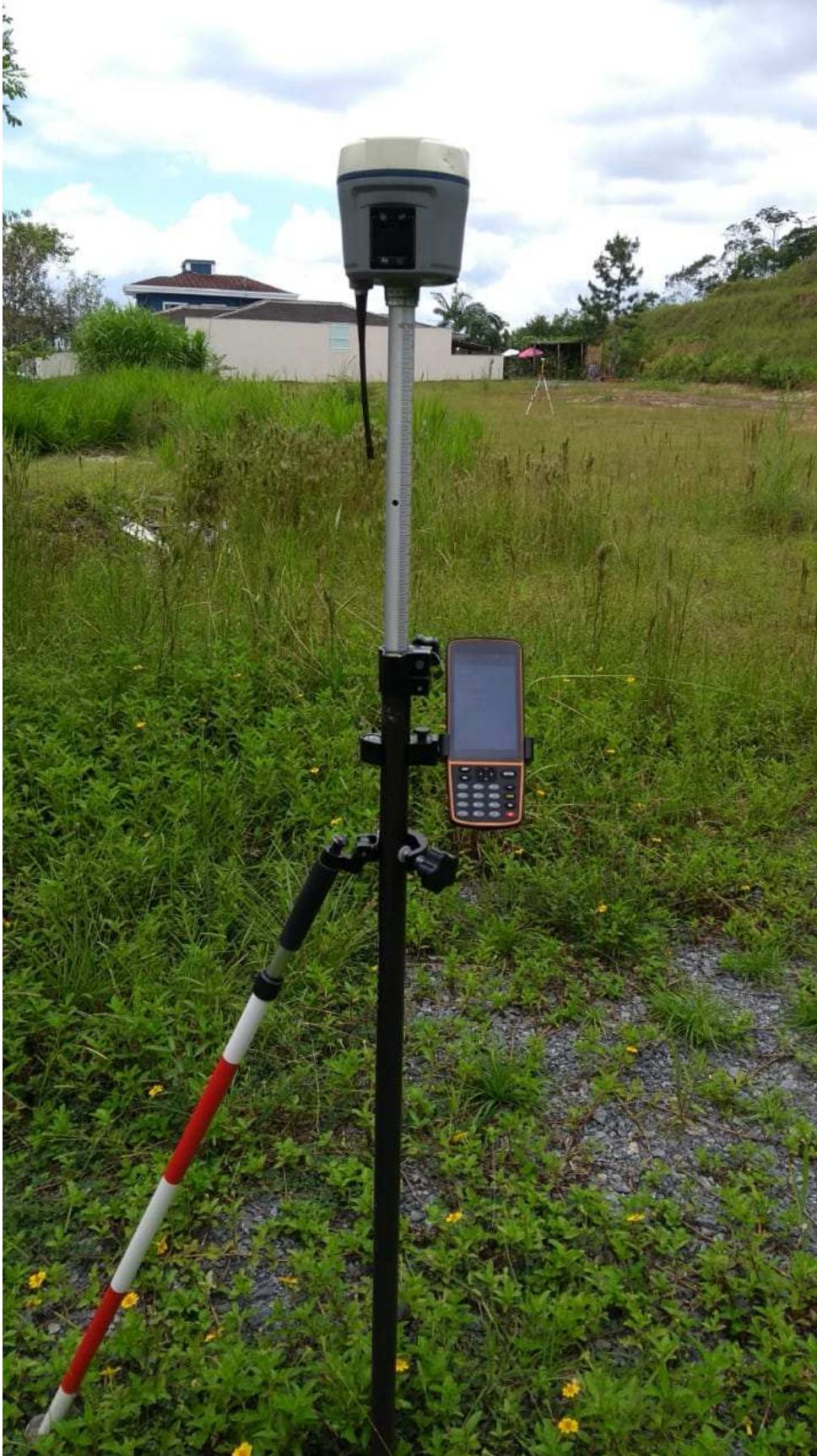
Vista do GPS Rover montado em um bipé e aos fundos o GPS Base montado no tripé.
