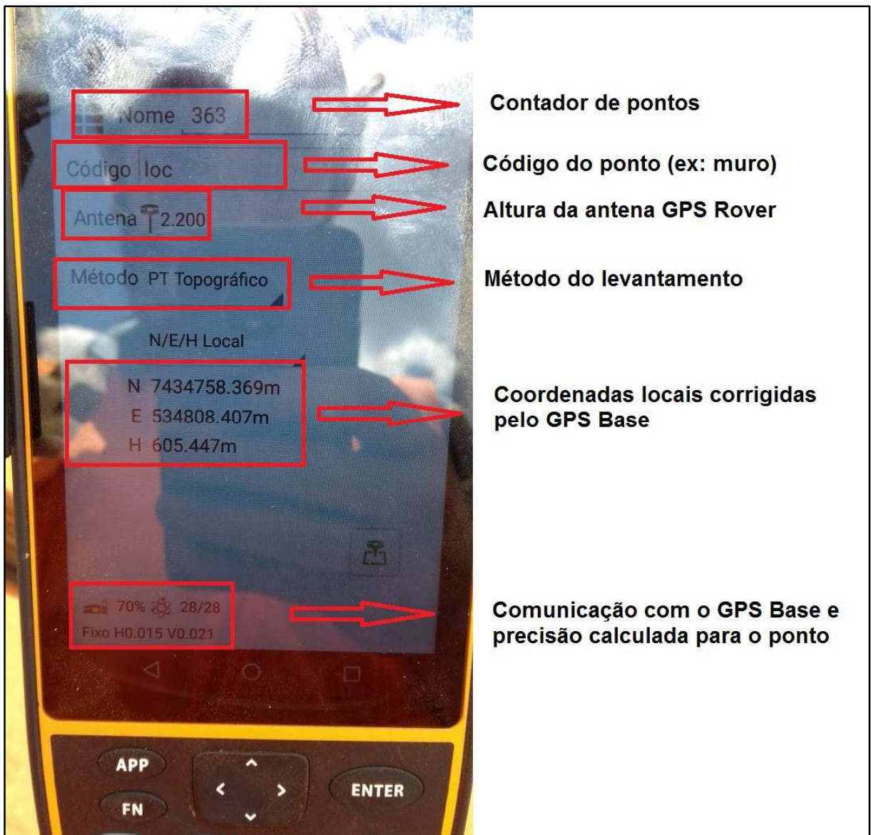
FIGURA 3 - CONTROLADORA EXECUTANDO O LEVANTAMENTO
