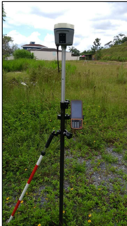
FIGURA 5 - GPS ROVER EXECUTANDO O LEVANTAMENTO PLANIALTIMÉTRICO
