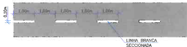
DETALHE C LINHA SIMPLES SECCIONADA BRANCA (1X1X1) - LINHA DE CONTINUIDADE
