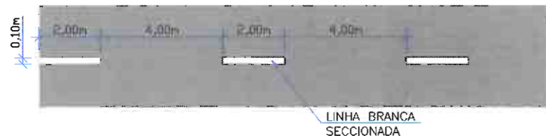
DETALHE C LINHA SIMPLES SECCIONADA BRANCA (1X1X1) - LINHA DE CONTINUIDADE
