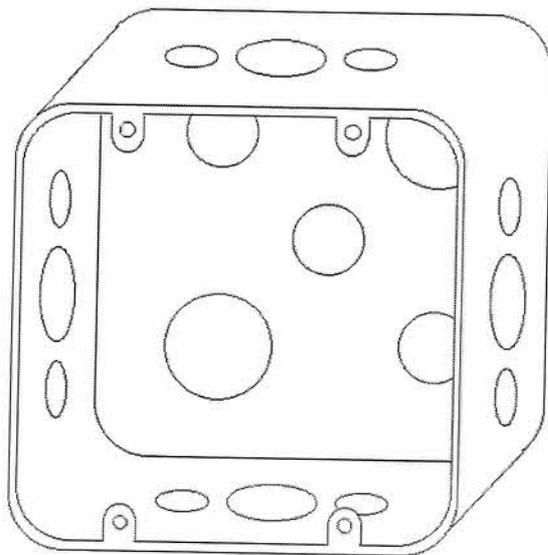
A primeira caixa para tomada deve ser sempre a de número 1. As demais caixas adotadas serão de número 0, sendo interligadas as caixas de tv a cabo e de telefonia quando instaladas lado-a-lado. A figura a seguir apresenta uma caixa de saída, com a tomada telefônica, com o terminal RJ-11, utilizada neste projeto.
