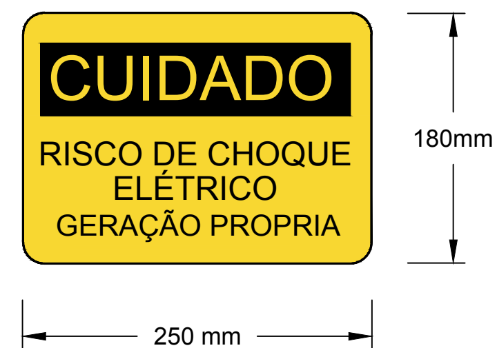
PLACA A SER INSTALADA SOBRE O INVERSOR SEM ESCALA
