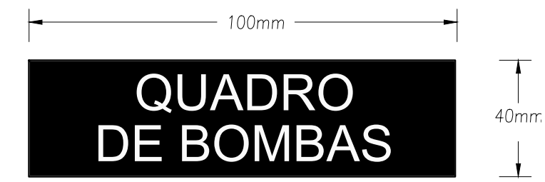
PLAQUETA DE IDENTIFICAÇÃO DO QUADRO DE DISTRIBUIÇÃO
