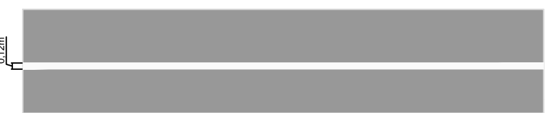
DETALHE B LINHA SIMPLES SECCIONADA BRANCA (2X4X2)
