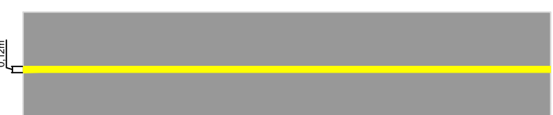
DETALHE F LINHA SIMPLES SECCIONADA AMARELA (2X4X2)
