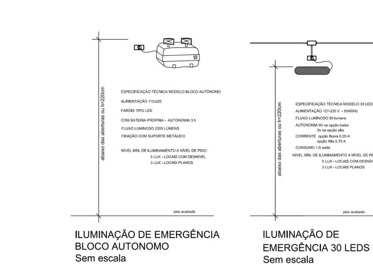
**ILUMINAÇÃO DE EMERGÊNCIA BLOCO AUTÔNOMO Sem escala**
