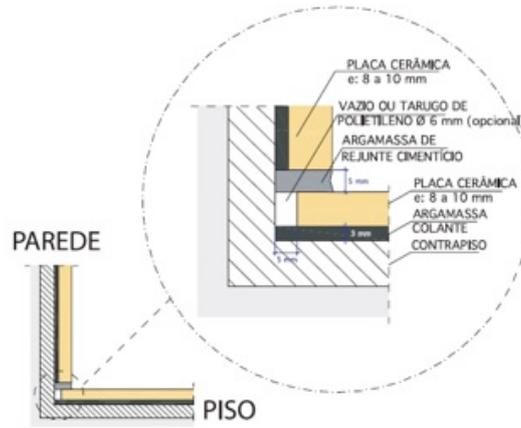
Detalhe da junta de dessolidarização entre revestimento de piso e parede ou rodapé com espessura de 8 a 10 mm.
