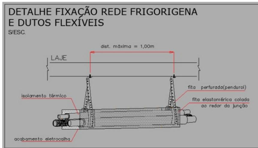
Os suportes deverão ser preferencialmente apoiados em elementos estruturais e nunca em paredes ou elementos de alvenaria.
