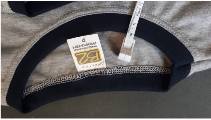
Foto 3 - Cota C - Altura da Cava.
