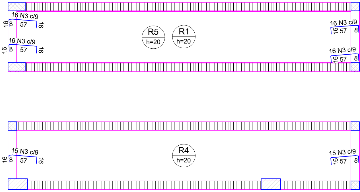
Armação negativa das lajes do pavimento Superior (Eixo X)
