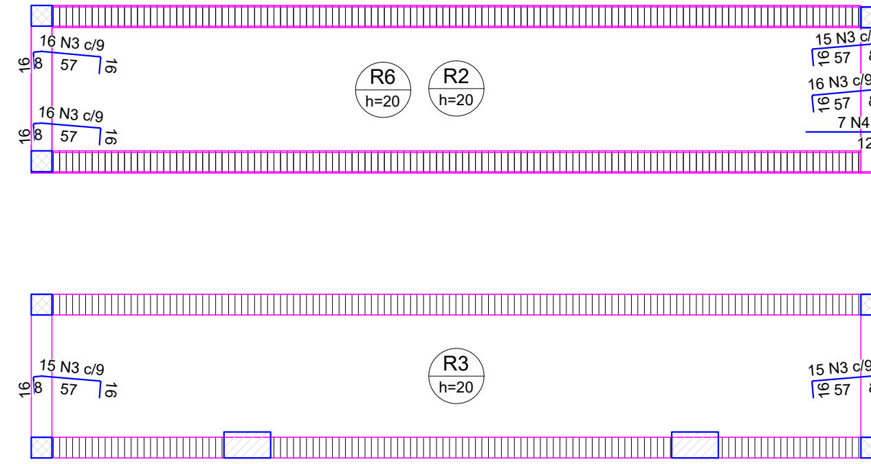
Armação negativa das lajes do pavimento Superior (Eixo X)
