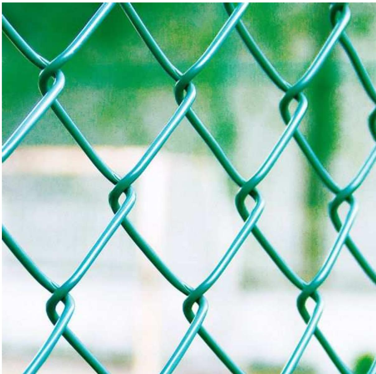
9 – Tela alambrado crimpada e galvanizada, revestida em PVC, na cor verde. Malha de 50 x 150 mm, fio podendo variar de 2,00 mm (mínimo) até 2,5 mm (máximo), com 1,0 m de altura. Instalada.
