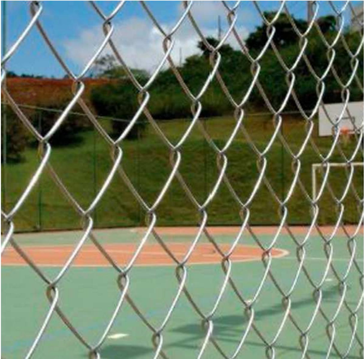
3 – Tela alambrado revestida em PVC na cor verde, fabricada em camada leve de Zinco, malha de 60 x 60 mm, fio 14 mm. Instalada
