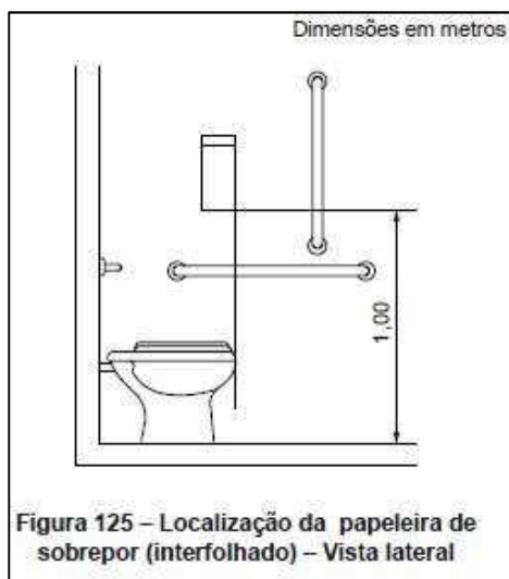
Figura 15 - Instalação de papelreira nos sanitários acessíveis. Fonte: NBR 9050/2020
