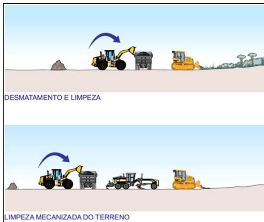
Figura 8 - DETALHE DA LIMPEZA DO TERRENO
