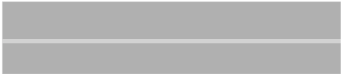
DETALHE A LINHA SIMPLES CONTÍNUA BRANCA - LARGURA = 10 CM
