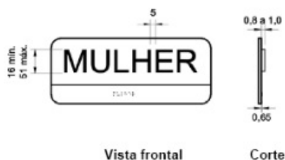
Sinalização em Braille. Fonte: NBR 9050/2004
