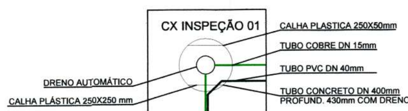
DETALHE CAIXA DE PASSAGEM Escala: 1/25
