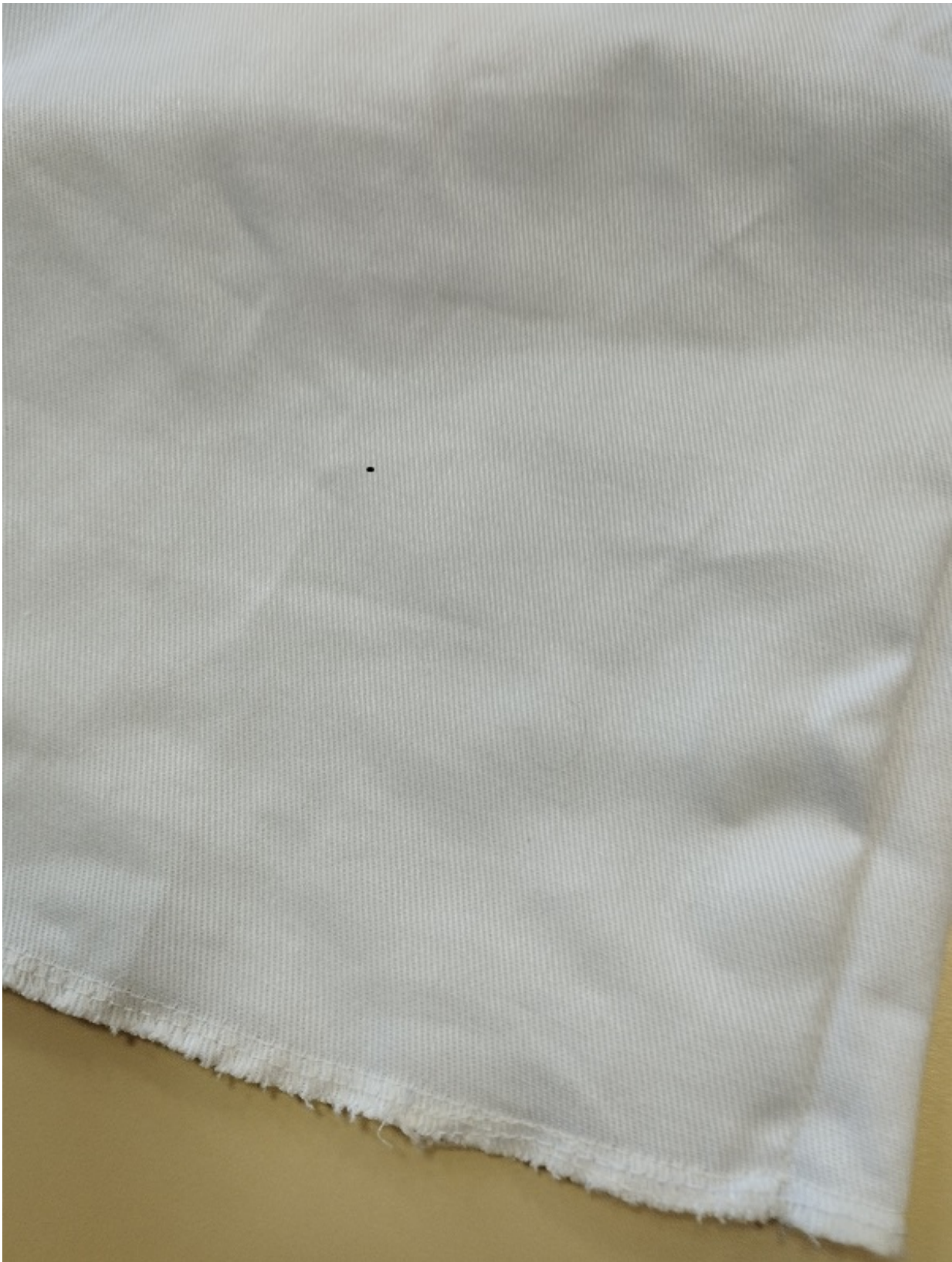
Foto 4. Ausência de bainha na barra da peça
