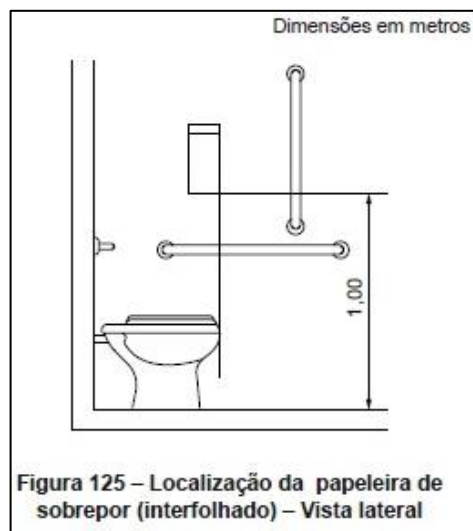
Figura 18 - Instalação de papeladeira nos sanitários acessíveis. Fonte: NBR 9050/2020
