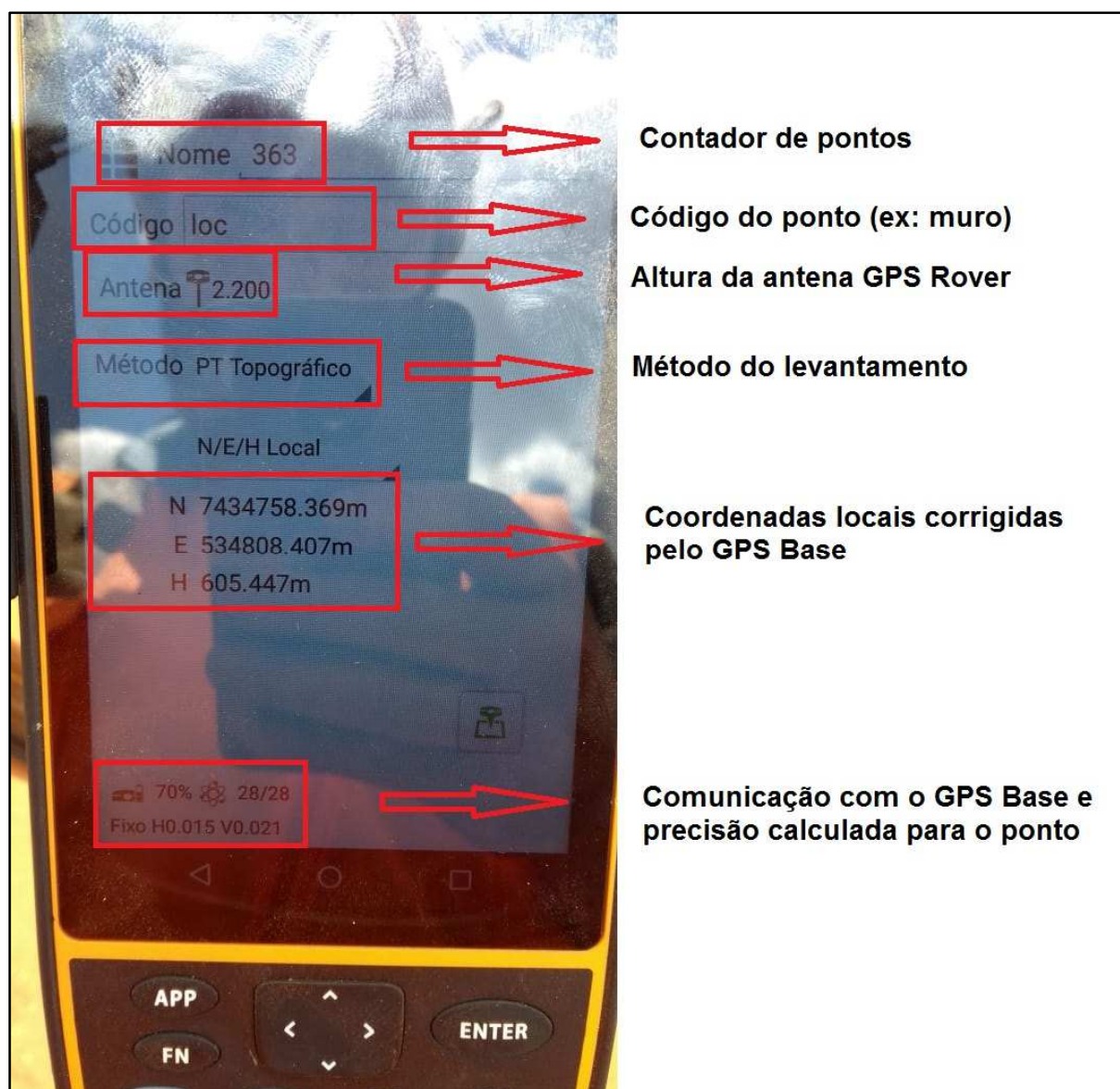
FIGURA 3 - CONTROLADORA EXECUTANDO O LEVANTAMENTO
