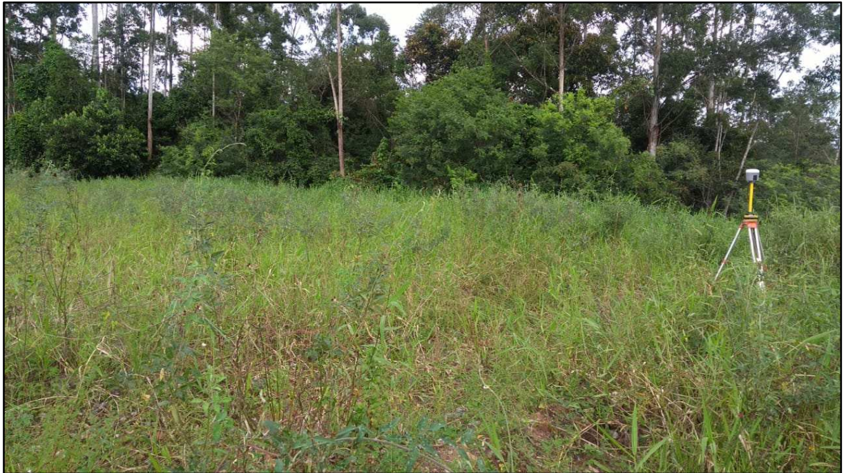
FIGURA 4 – GPS BASE EXECUTANDO O LEVANTAMENTO TOPOGRÁFICO
