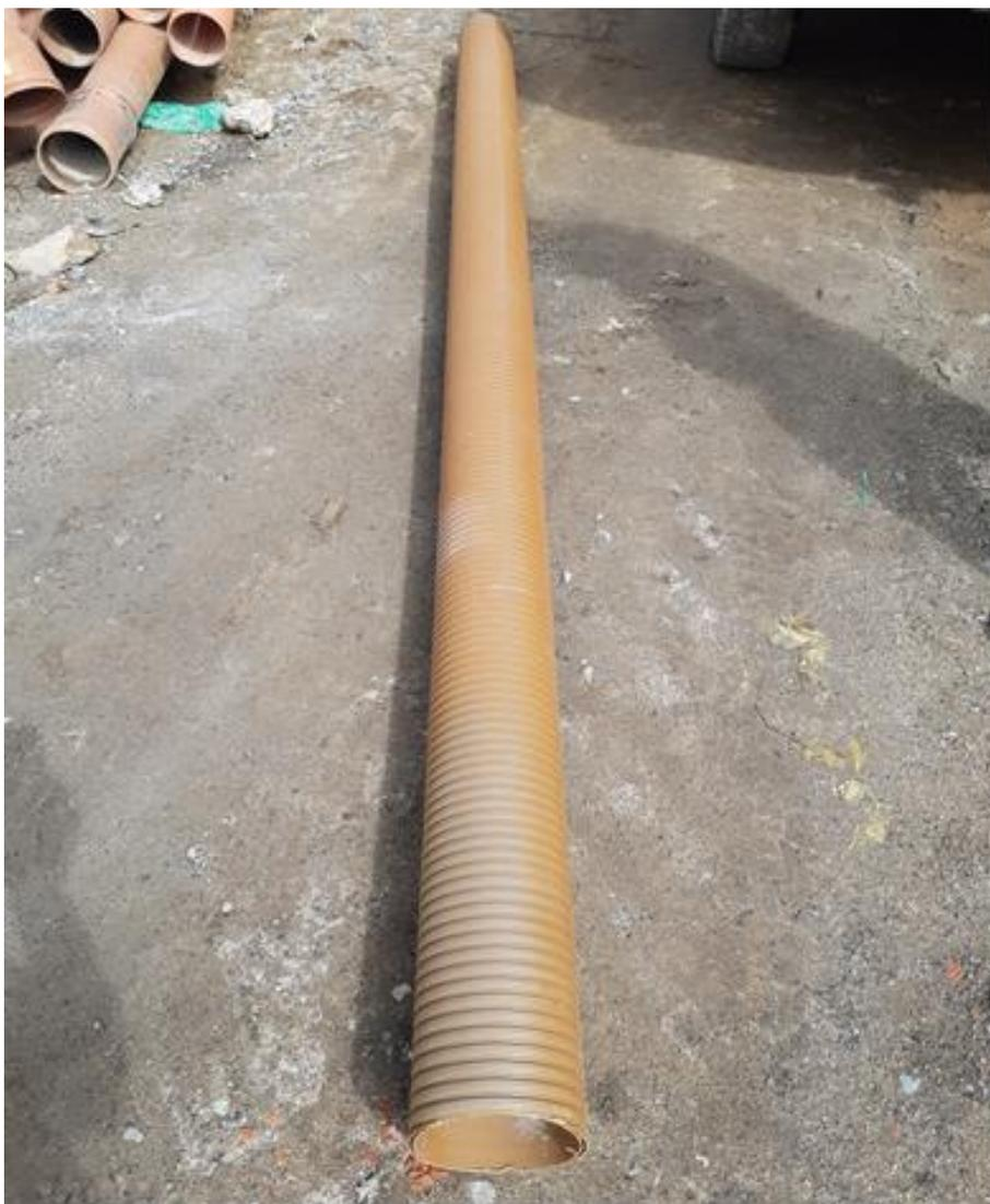
Foto 2 - Tubo de revestimento das paredes dos poços.
